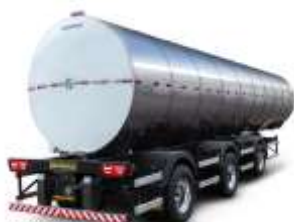
Tanque Inox Isotérmico para Alimentos
